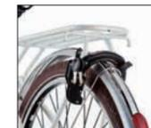
頑丈なリング形状のロックを自転車後部に標準装備。リング錠のカギとバッテリーを固定するカギは同じ鍵で統一されています。
